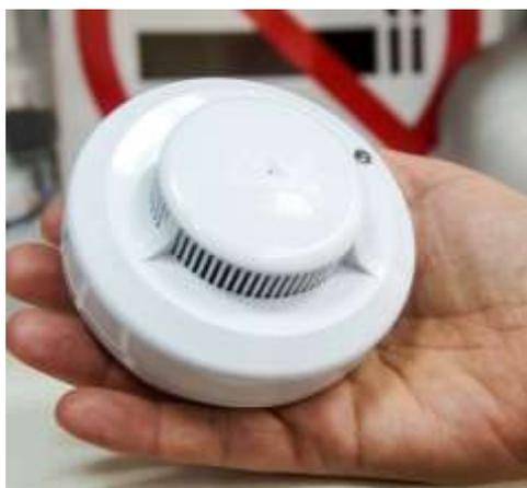
Автономный пожарный извещатель – это прибор, реагирующий на определенный уровень концентрации аэрозольных продуктов горения (пиролиза) веществ и материалов, в корпусе которого конструктивно объединены автономный источник питания и компоненты, необходимые для обнаружения пожара и непосредственного оповещения о нем.
